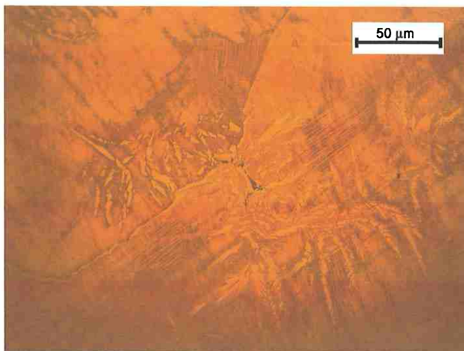
Figura 7 – agulhas de \gamma' crescendo próximas a um contorno de grão.
