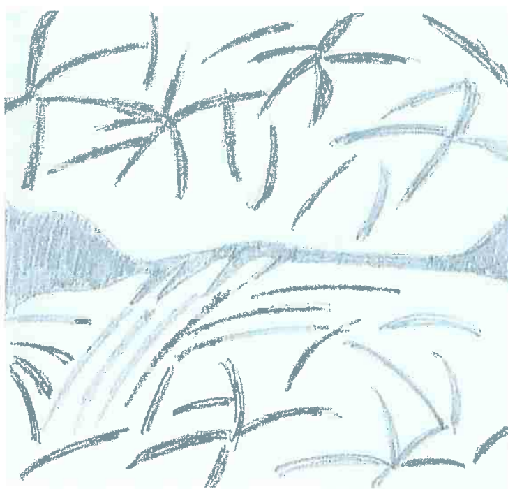
Figura 39 – Desenho esquemático do precipitado em forma de “folhas de bananeira”
