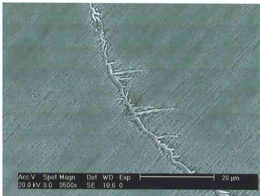
Figura 33 – (MEV-elétrons secundários) Amostra 7: região de encontro entre duas dendritas
