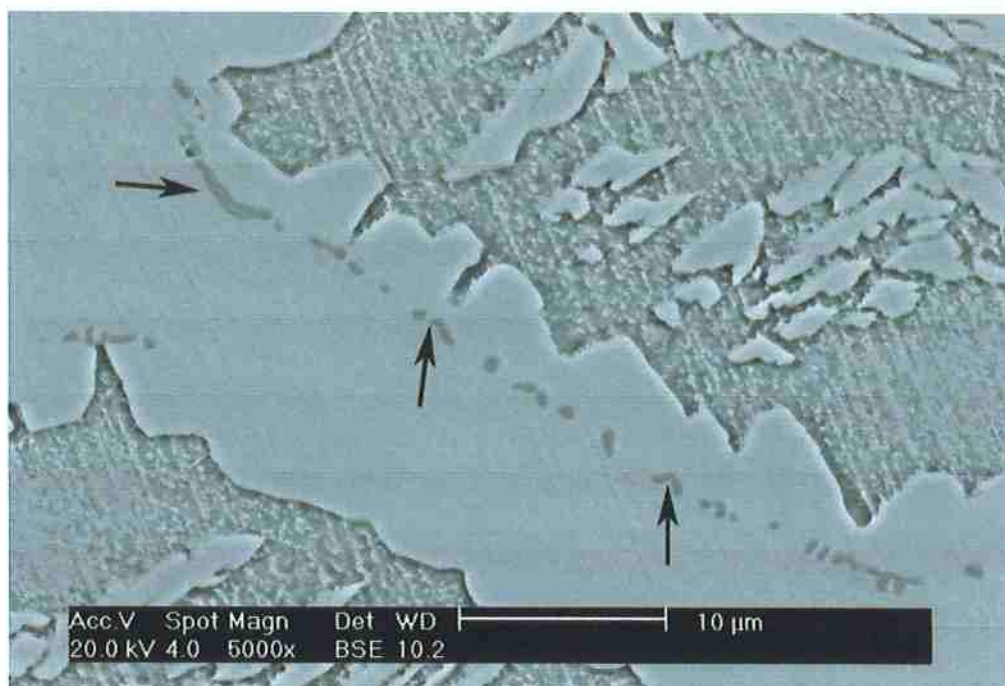
Figura 19 – (MEV-elétrons retroespalhados )Amostra 1: detalhe da fase rica em cromo
